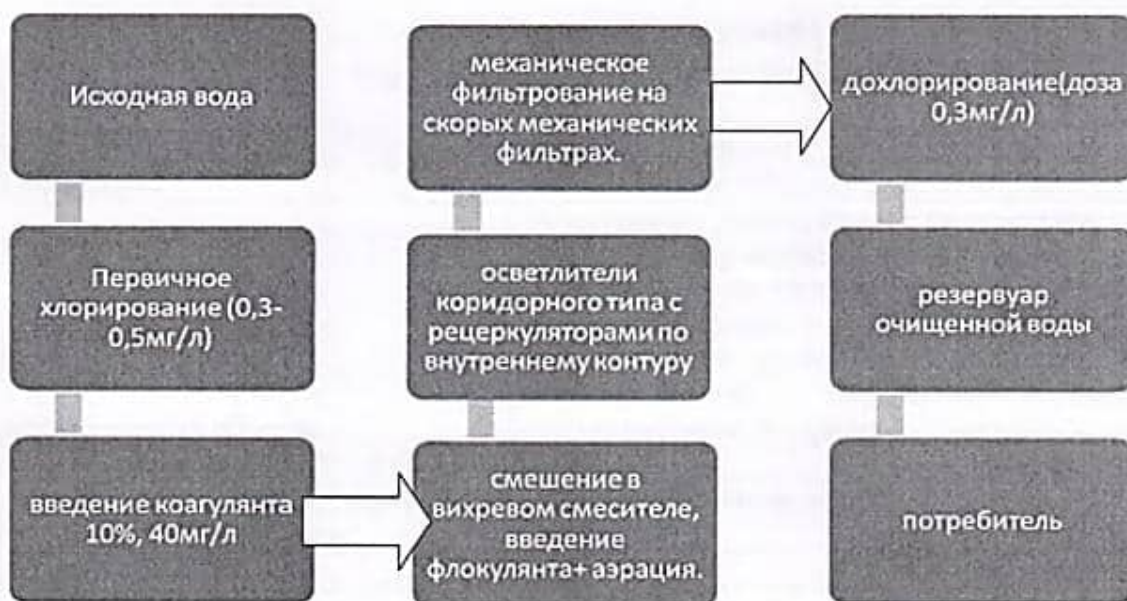
Рис. 1. Блок-схема очистных сооружений водопровода.
