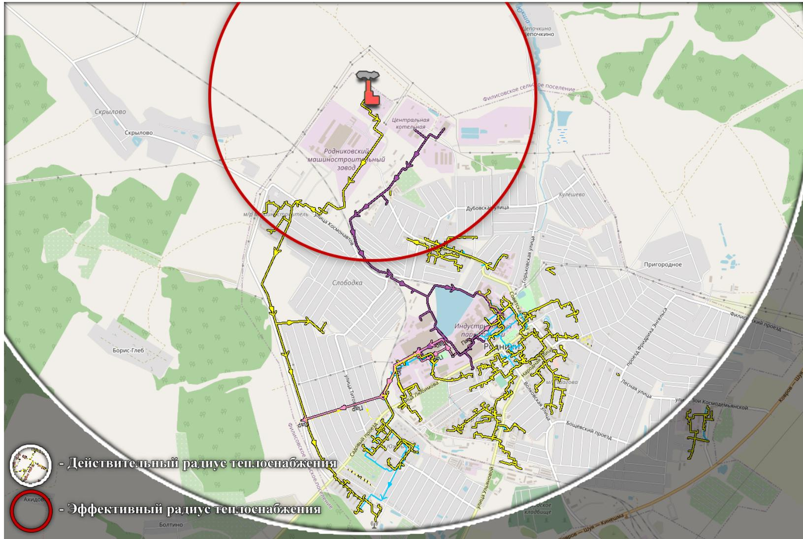
Рисунок 2.2 - Действительный и эффективный радиусы теплоснабжения котельной ЗАО «Родниковский Машиностроительный завод»
